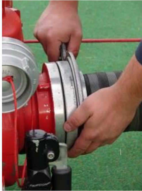
Abb.24a: Angesetzter Kupplungsschlüssel – kein „klopfen“, sonst „Falsches Arbeiten“
