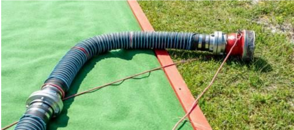
Abb.23: Ablegen des Saugkorbes jenseits der Wasserlatte
