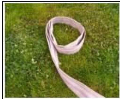
Abb.33b: Schlecht ausgelegter Druckschlauch
