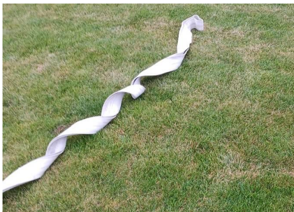
Abb.33a: Schlecht ausgelegter Druckschlauch
