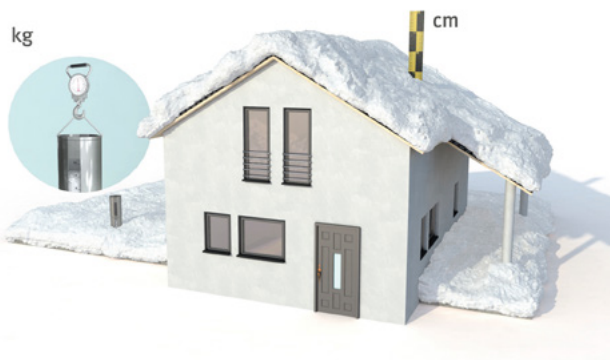
Abb. 7 Messung mittels Messrohr und Pegel
