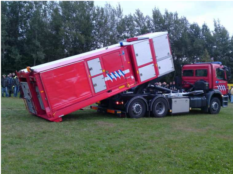
Wechsellaufbaufahrzeug setzt Pumpencontainer ab
