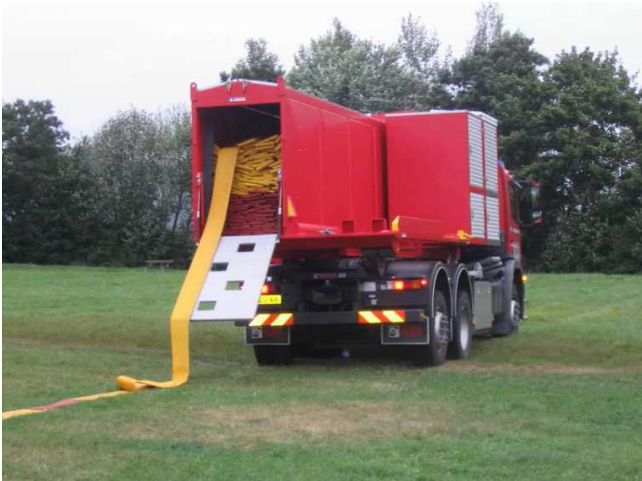
Verlegung der F-Schläuche
