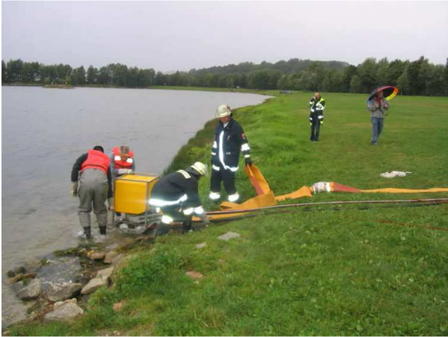
Schwimmfähige Kreiselpumpe wird zu Wasser gelassen
